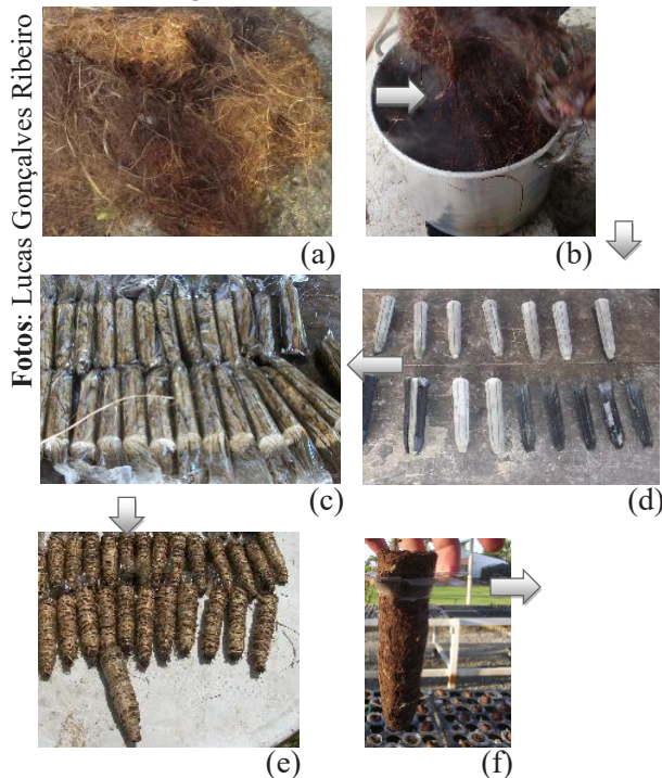
Figura 1. Etapas da confecção dos recipientes orgânicos: a) cascas de fibras, e fibras curtas e finas; b) cozimento das fibras; c) confecção dos moldes; d) moldes envoltos por sacos plásticos untados com óleo; e) composto de fibras aderidos aos moldes e envolvidos com palha da costa para secagem; f) recipiente pronto para utilização.
