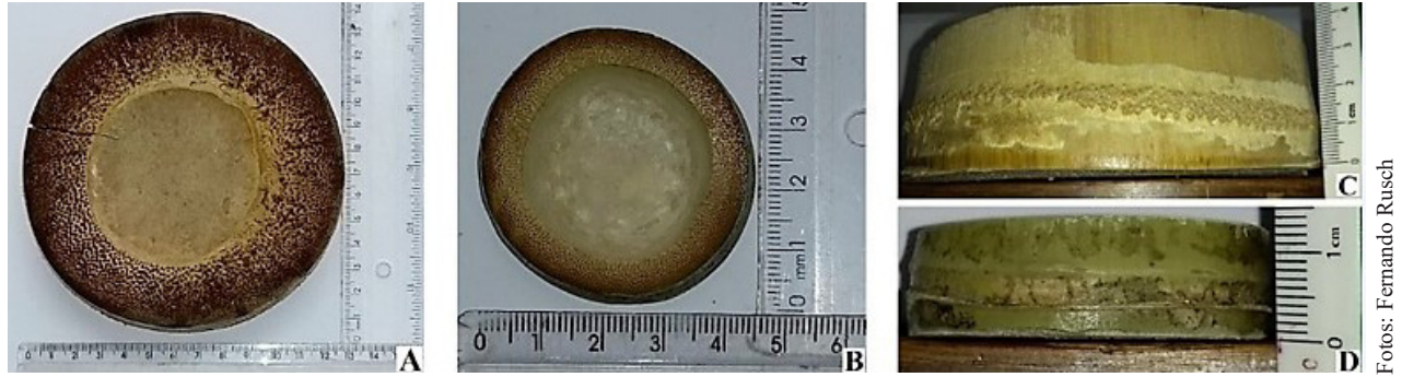
Figura 1. Representação transversal e axial do colmo de duas espécies de bambu. Seção transversal na região do nó: A) Dendrocalamus asper e B) Phyllostachys aurea . Seção axial na região do nó: C) Dendrocalamus asper e D) Phyllostachys aurea .
