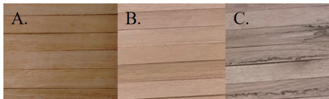
Figura 2. Aparência natural da madeira de Eucalyptus grandis e após tratamentos térmicos, A = controle, B = tratamento de congelamento, C = tratamento de aquecimento em água.
