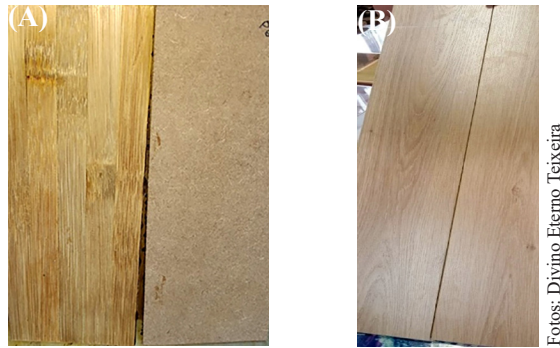
Figura 3. Piso laminado bambu-MDF, faces superior/inferior (A) e piso laminado comercial (B).
